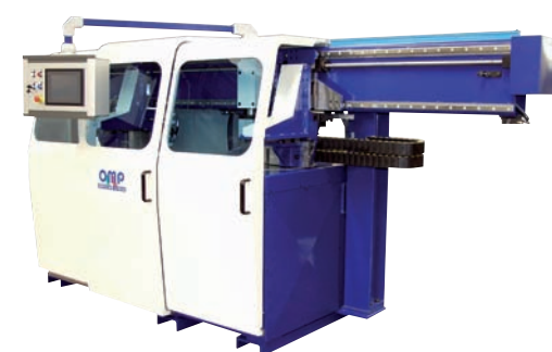
KR3 EQUIPO DE CORTE CON DISCO ASCENDENTE Y DOBLE PINZA DE ALIMENTACIÓN PARA SOBRENTE O
